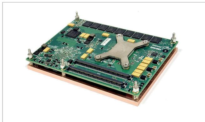
**Рис.2.** Компьютерный модуль формата COM-Express
